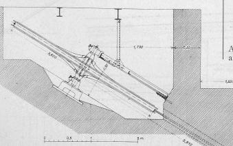
Abb. 3. Die Seilrollenkammer der alten Anlage. Längsschnitt. — Masstab 1:50.
