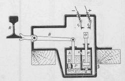
Abb. 6. Schematische Darstellung des Schienenkontakts.
