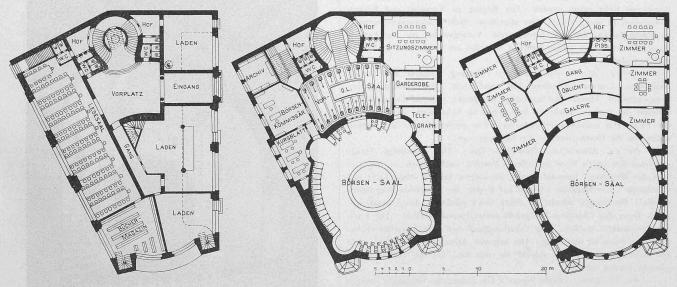
Grundrisse vom Erdgeschoss sowie vom ersten und zweiten Obergeschoss. — Masstab 1:500.
