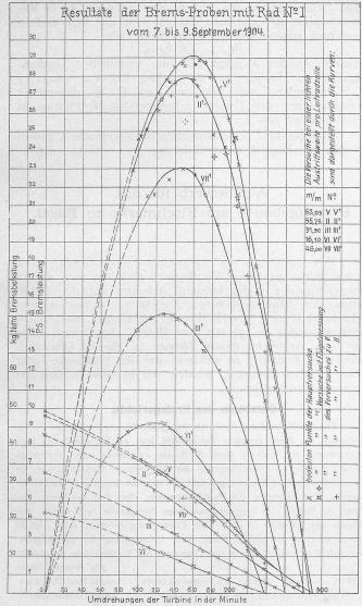
Abb. 17. Bremsproben-Ergebnisse bei Rad II.
