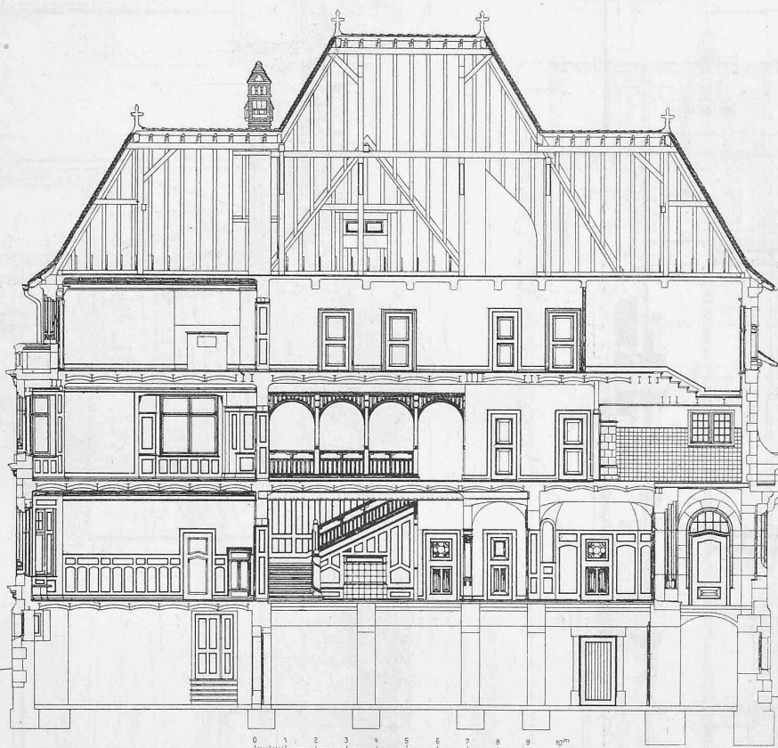
Abb. 7. Längsschnitt durch die Halle. — Masstab 1:200.
