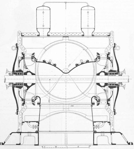
Abb. 16. Die 6000 P. S. Doppel-Francisturbine der Shavinigan Water Power Co. — Schnitt durch die Turbinenwelle. — Masstab 1:40. Erbaut von Escher Wyss & Cie. in Zürich.
