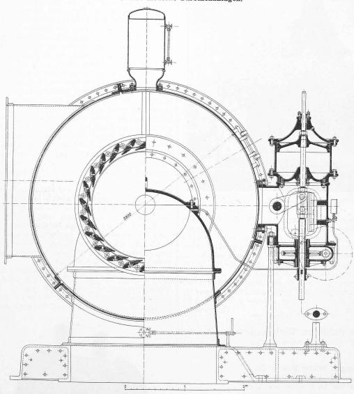
Abb. 15. Die 6000 P. S. Doppel-Francisturbine der Shavinigan Water Power Co. — Schnitt senkrecht zur Turbinenwelle. — Masstab 1:40.
