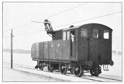
Abb. 14. Umformerlokomotive mit dem neuen Stromabnehmer.
