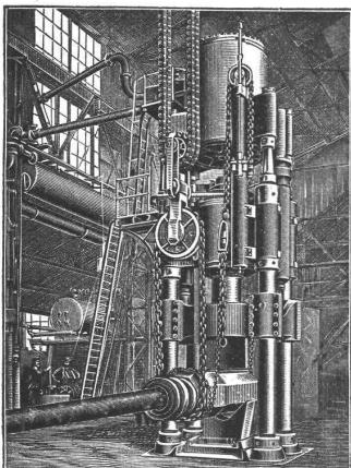
Dampfhydraulische Schmiedepresse. Stahlformguss bis zu 50 000 kg Stückgewicht.
