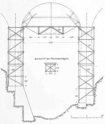
Abb. 22. Baugerüst für den Tischbach-Viadukt. — Masstab I: 350.
