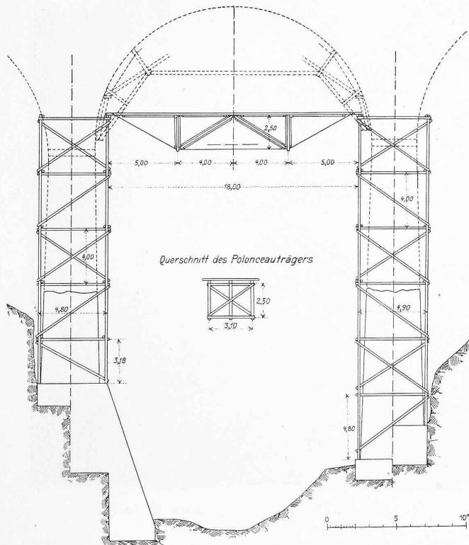
Abb. 22. Baugerüst für den Tischbach-Viadukt. — Maßstab 1:350.
