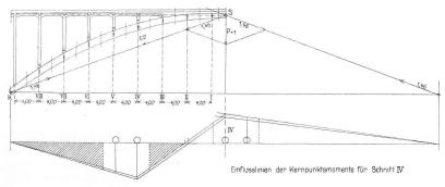
Abb. 18. Statische Berechnung. — Masstab 1:600.
