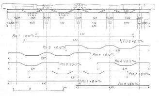
Abb. 15. Armierung der Fahrbahnplatte. — Masstab 1:100.
