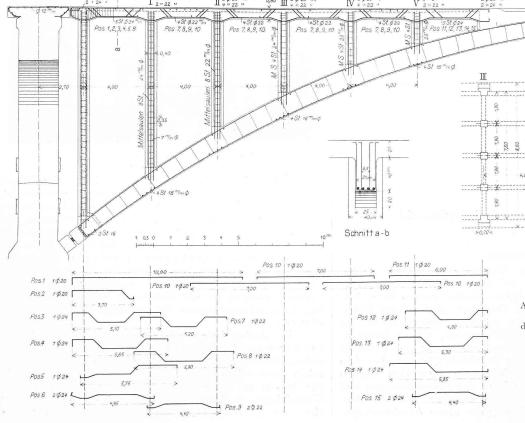
Abb. 14. Armierung der Fahrbahnträger, der Säulen und des Gewölbes.
