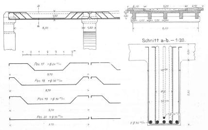
Abb. 16. Fahrbahnkonstruktion zwischen den Landpfeilern am linken Ufer. — 1:200.
