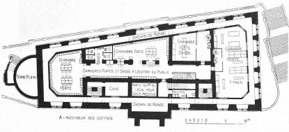
Fig. 3. Plan du premier sous-sol. — Echelle 1:600.
