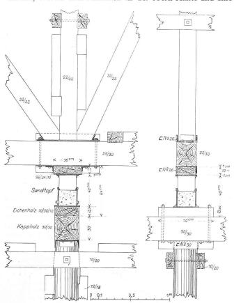
Abb. 9. Detail des Lehrgerüstes der Isarbrücke. - Masstab 1:30.
