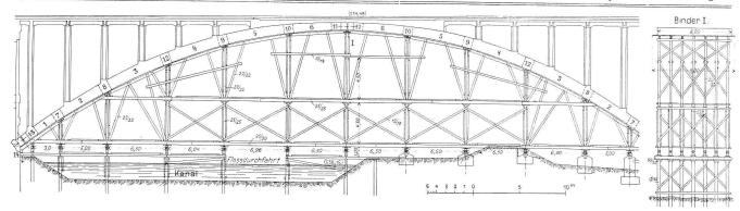
Abb. 8. Das Lehrgerüst der Isarbrücke. Linke Stromöffnung. — Ansicht und Querschnitt. — Masstab 1:400.
