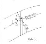
tracht, und es ergeben sich, wenn der normale Querschnitt senkrecht zur Drucklinie für Eigengewicht angenommen wird, folgende Gleichungen der Momente für Eigengewicht:
