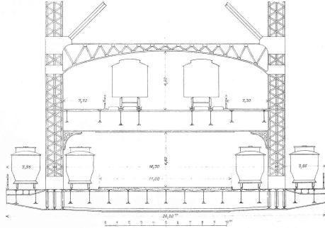
Abb. 34. Die Blackwells Insel-Brücke. - Querschnitt. - Masstab I: 200.
