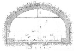
Abb. 27. Normalprofil des dreigeleisigen Tunnels in Manhattan.
