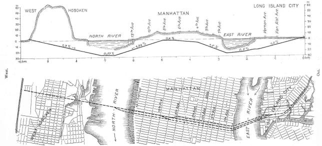
Abb. 24. Die Tunnelanlage der Pennsylvaniabahn unter dem East River, Manhattan und dem North River. Lageplan und Längenprofil. — Masstab I:60000 für die Längen, I:3000 für die Höhen.
