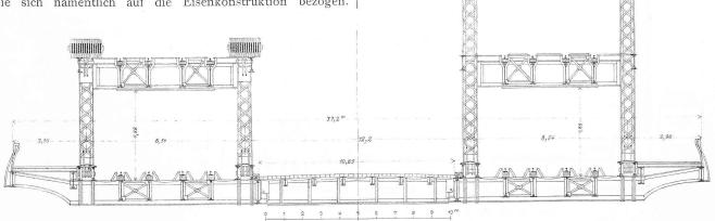
Abb. 31. Die Manhattanbrücke. — Querschnitte. — Masstab 1:200.
