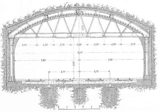
Abb. 26. Profil der viergeleisigen Strecke des Tunnels unter dem North River. — Masstab I: 200.
