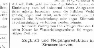
I. In den Handbüchern für Strassenbau findet man häufig die Vorschrift: in engen Kurven sei die Längsneigung einer Strasse zu reduzieren mit Rücksicht auf die beim Befahren derselben eintretenden Kraftverluste.
