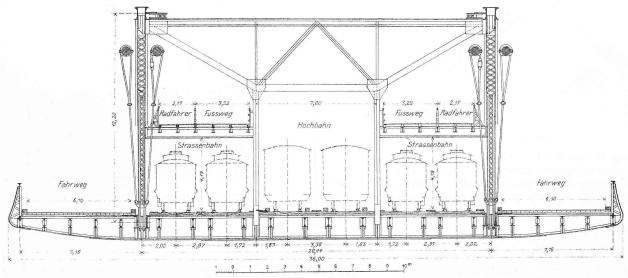
Abb. 23. Querschnitt durch die Williamsburgbrücke. — Masstab 1:200.
