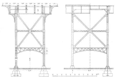
Abb. 13. Turmpfeiler des Manhattanviaduktes. — Masstab 1:200.
