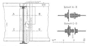
Abb. 14. Expansionsstoss der Blechträger am Manhattanviadukt. Masstab 1:50.
