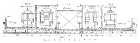
Abb. 17. Querschnitt durch die Brooklynbrücke. — Masstab 1:200.
