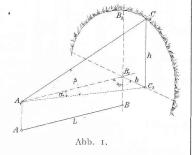
AB = L vom Profil werde das Instrument aufgestellt. Das Zentrum des Instrumentes sei  $A_1$ , die horizontale Visur in der Richtung von AB heisse  $A_1B_1$ .
