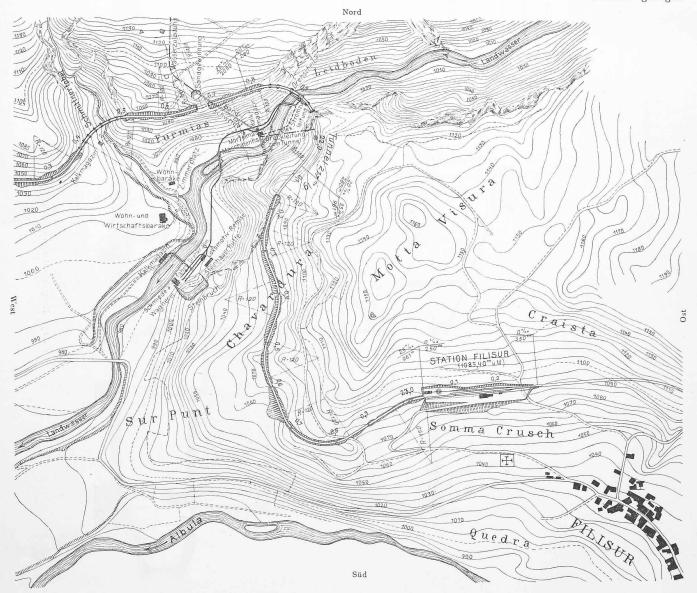
Abb, 8. Lageplan der Linienführung über die Landwasserschlucht bis zur Station Filisur. — Masstab 1:7500.
