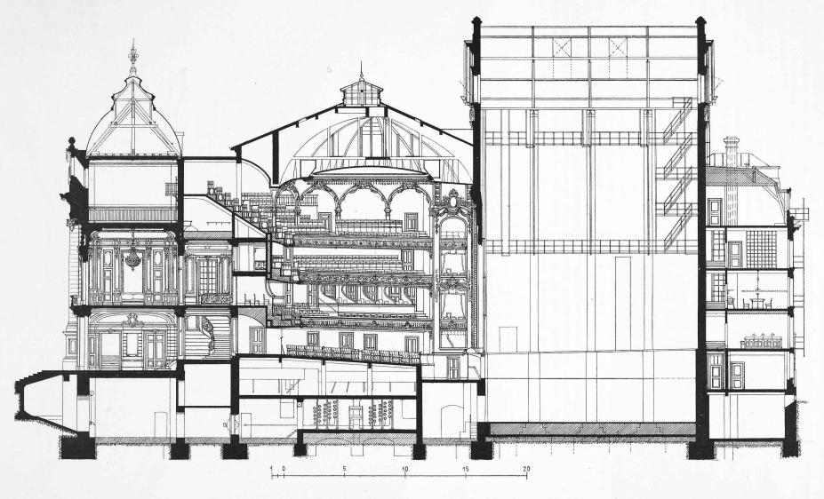
Abb. 15. Längsschnitt durch das Foyer, den Zuschauerraum und das Bühnenhaus. — Masstab 1:250.
