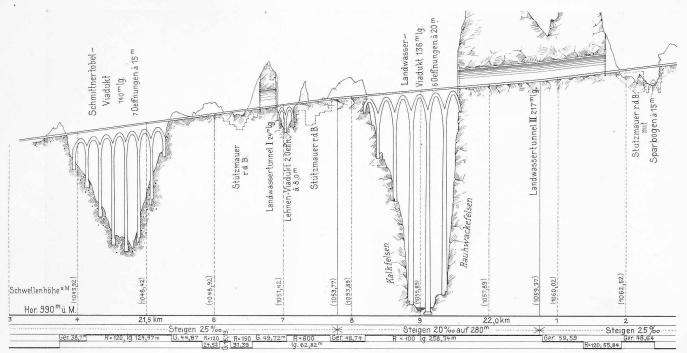
Abb. 9. Längenprofil der Uebersetzung des Schmittentobel und der Landwasserschlucht. — Masstab 1:5000 für die Längen, 1:1000 für die Höhen.
