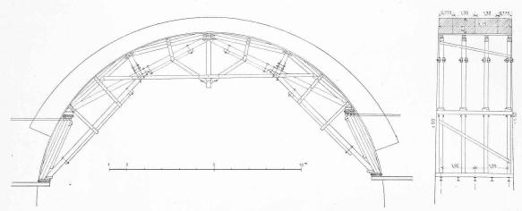
Abb. 17. Lehrbogen des Landwasserviaduktes. - Masstab 1:175.
