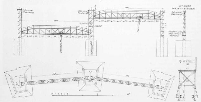
Abb, 13. Der Landwasserviadukt. — Verstellbares Aufzugsgerüst für den Bau der Mittelpfeiler. — Masstab 1:350.
