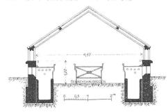
Abb. 3. Querschnitt durch das Gewächshaus der Villa Montfleuri in Bern. — Masstab 1:100,
