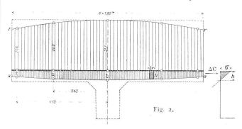
Ces épreuves comportent trois séries d'observations. Les deux premières séries ont été effectuées au Laboratoire de l'Ecole des Ponts et Chaussées sur deux dalles à section T; la troisième sur un plancher construit par la Maison Potin. Première épreuve. — Dalle nervée de 2,90 m de portée et 1,20 m de largeur chargée uniformément sur toute sa surface.
