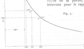
de la largeur efficace à la largeur totale du hourdis les chiffres suivants:
