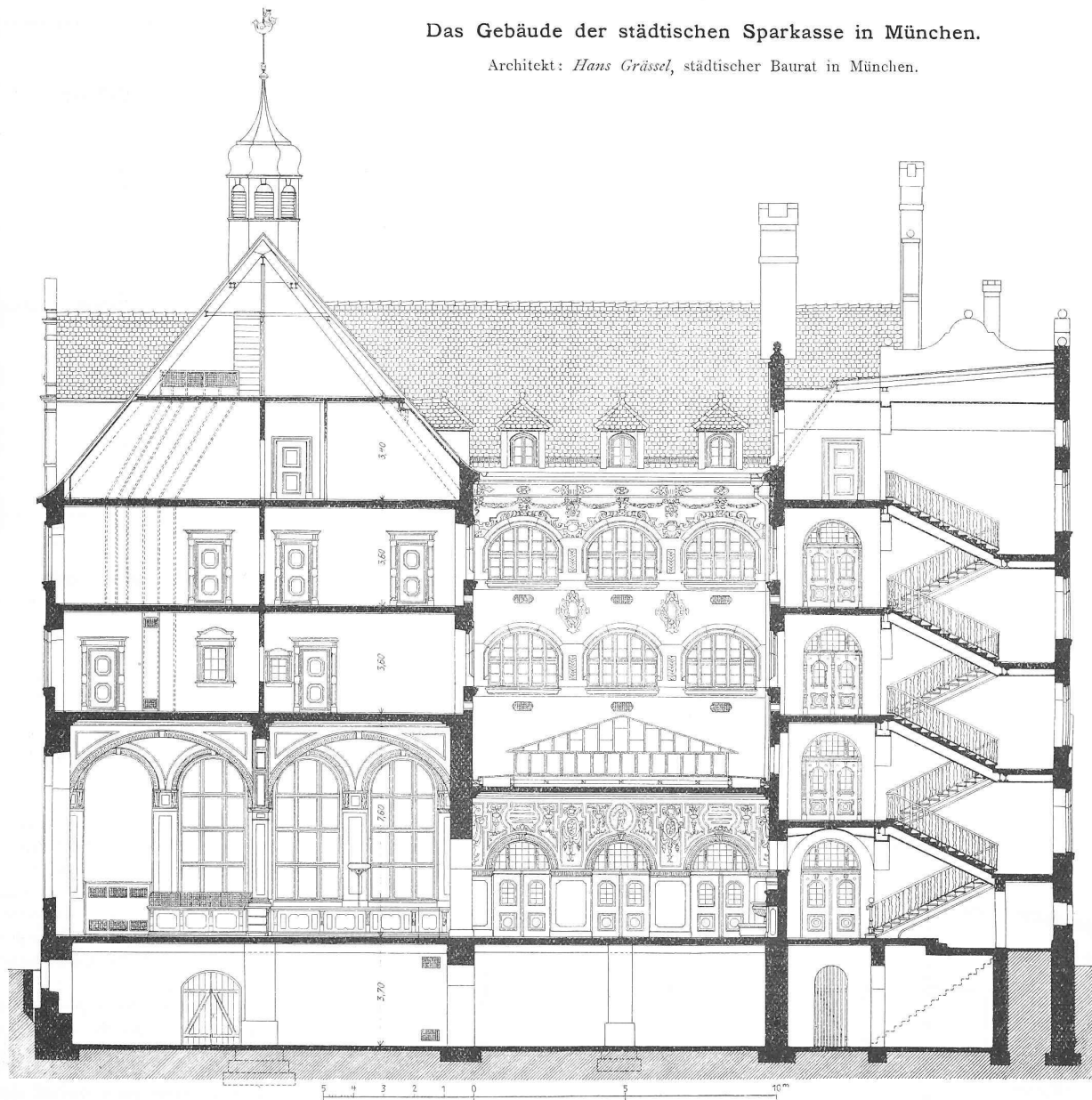
Abb. 5. Querschnitt durch das Gebäude. — Masstab 1 : 200.
