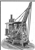
zum Abgraben von Erdmassen und Verladen derselben in Wagen, auch als Kran zum Heben von Lasten und als Greifbagger verwendbar.
