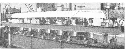
Abb. 3. Balken Profil Nr. 18 auf der Biegemaschine mit den Brucherscheinungen.
