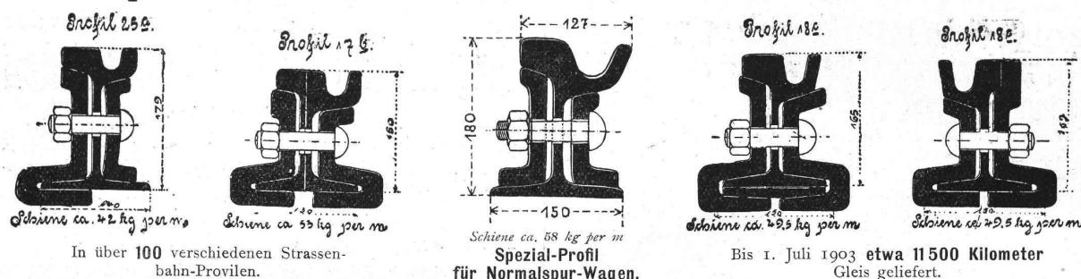
Die bisherige beste Lösung der Stossfrage ist Anwendung der **Fusslaschen**. Die Fusslasche garantiert dauernd stossfreies Befahren. **Weichen** und Kreuzungen bewährtester Bauart mit neuester Zungenbefestigung, Federung und Entwässerung. **Normale Verlaschung** mit Blattstoss-Halbstoss bzw. Fusslaschen an allen Weichenstössen. **Auflaufweichen** zu Notgleisen. Hilfsgeräte zu Gleisverlegungsarbeiten, Lochpresse, Biegebügel.
