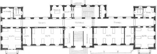
Fig. 63. Hôpital communal à la Chaux-de-Fonds, — Plan du rez-de-chaussée. — Echelle 1:400.
