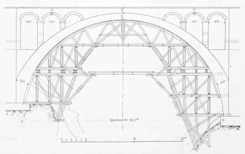
Abb. 7. Lehrgerüst für die Hauptöffnung der Solisbrücke. — Masstab 1:350.
