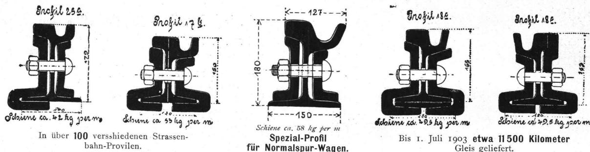
Die bisherige beste Lösung der Stoßfrage ist Anwendung der Fusslaschen. Die Fusslasche garantiert dauernd stoßfreies Befahren. Weichen und Kreuzungen bewährtester Bauart mit neuester Zungenbefestigung, Federung und Entwässerung. Normale Verlaschung mit Blattstoß-Halbstoß bzw. Fusslaschen an allen Weichenstößen. Auflaufweichen zu Notgleisen. Hilfsgeräte zu Gleisverlegungsarbeiten, Lochpresse, Biegebügel..
