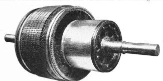
Abb. 2. Armatur des 1000 P.S. Gleichstrom-Generators.
