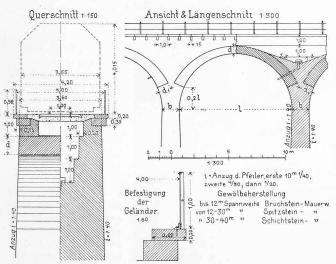
Abb. 1. Normalien für die Viadukte der Albulabahn.
