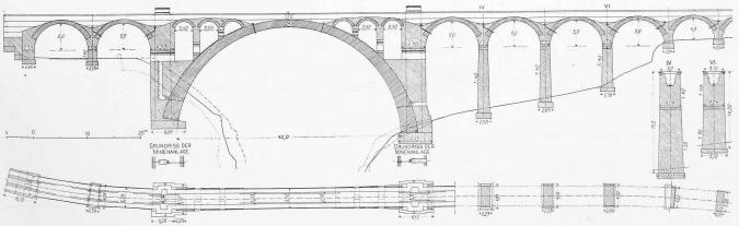
Abb. 5. Längenschnitt, Grundriss und Pfeiler der Solisbrücke. — Masstab 1:700.
