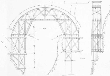
Abb. 3. Lehrgerüst des Muttentobel-Viaduktes. — Masstab 1:350.
