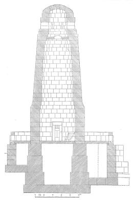
Längsschnitt durch das Denkmal. - Masstab I: 200.
