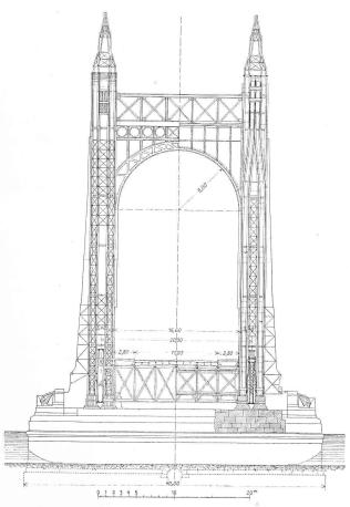
Abb. 3. Querschnitt und Frontansicht der Portalständer, Masstab 1:500.
