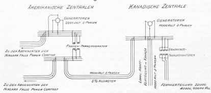
Abb. 3. Schema für den Gesamtanschluss und die Verteilungsanlage der drei grossen Niagarazentralen.
