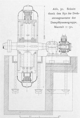
Jede Dynamo besitzt ihre eigene Erregermaschine, deren Anker auf der Welle freifliegend angeordnet ist, während das Magnetgestell auf dem Fundament des Aussenlagers der Hauptdynamo Platz gefunden hat.
