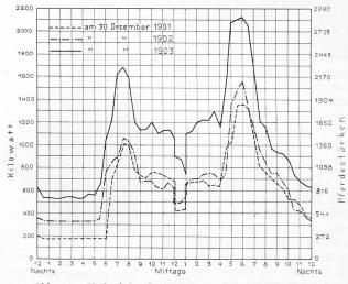
Abb. 55 Verlauf der Stromerzeugung an den Tagen der grössten Belastung.
