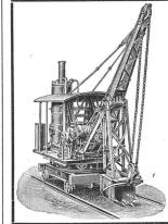
zum Abgraben von Erdmassen und Verladen derselben in Wagen, auch als Kran zum Heben von Lasten und als Greifbagger verwendbar.
