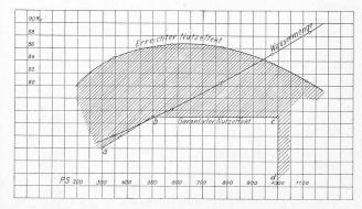
Abb. 42. Versuchsergebnisse mit der 1000 P. S. doppelten Löffelradturbine.
