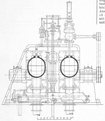
Abb. 39. Die 1000 P. S. Turbine mit Regulierung von Escher Wyss & Cie.
