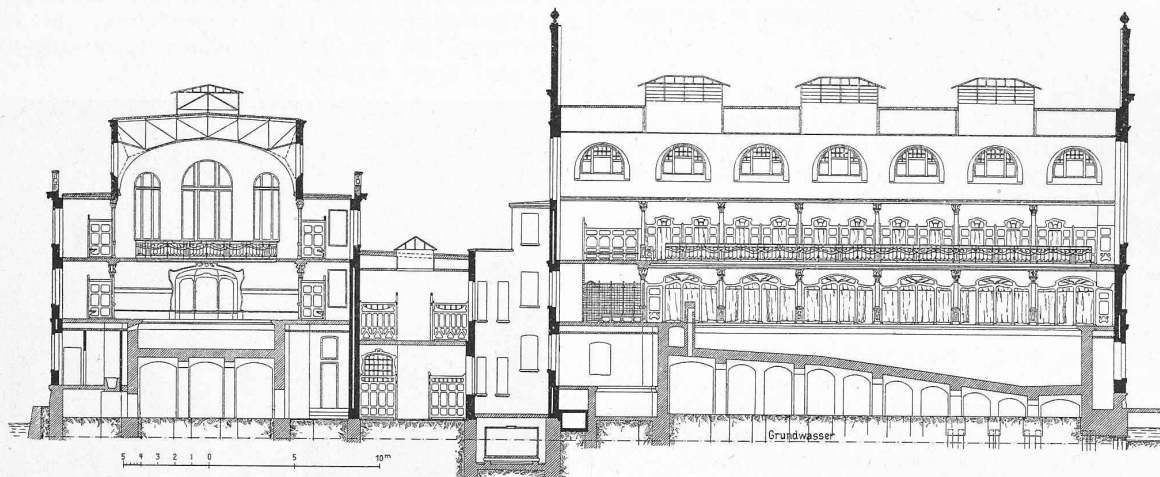
Abb. 6. Querschnitt durch die Frauenschwimmhalle und Längsschnitt durch die Männerschwimmhalle. — 1:400.
