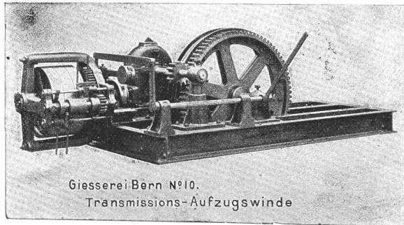
**Hebezeuge jeder Art** als: **Laufkräne**, und feste od. fahrbare **Drehkräne** für Hand- und speziell elektrischen Betrieb; **Aufzüge** für hydraulischen, elektrischen und Transmissionen.
