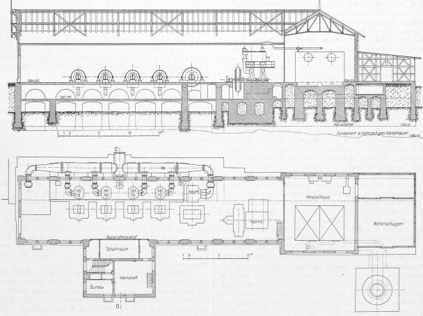
Abb. 33. Grundriss und Längenschnitt des Maschinenhauses. - Masstab 1:400.
