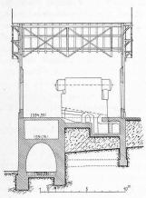
Abb. 35. Schnitt durch das Kesselhaus. Masstab 1:400.
