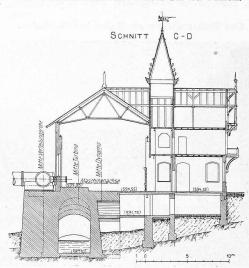
Abb. 34. Schnitt durch Maschinenhaus, Schaltraum und Werkstätte. — Masstab 1:400.
