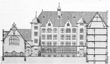
Schuitt durch Turnhalle und vordern Flügel mit Hoffassade. - Masstab 1:600.
