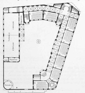
Grundriss vom Erdgeschoss. — Masstab 1:800.
