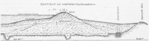
Abb. 24. Querschnitte durch den westlichen und den nördlichen Abschlussdamm des Stauweihers. — Masstab 1:700.
