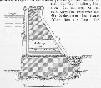
Abb. 15. Der Assuan-Staudamm. — Querschnitt. — Masstab 1:500.
