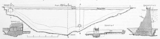
Abb. 15. Oestliche Abschlussmauer des Weihers. — Längsschnitt und Querschnitte. — Masstab 1:700.
