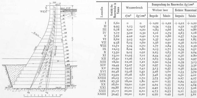
Abb. 18. Statische Berechnung der östlichen Abschlussmauer vom Sammelweiher. — Masstab des Querschnittes 1:300.
