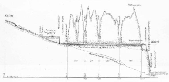
Abb. 7. Zuleitungsstollen vom Wehr in der Urnäsch bis zum Sammelweiher. — Längenprofil  $r:\frac{60000}{3000}$
