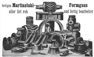
für Walz- und Hammerwerke: Spindeln, Muffen, Einbaustücke, Walzenständer, Kammwalzen, Zahnräder, Sättel, Hammerbäre etc. etc.
