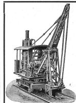
laden derselben in Wagen, auch als Kran zum Heben von Lasten und als Greifbagger verwendbar
