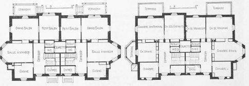
Fig. 33. Plan du rez-de-chaussée. Echelle 1:400. Fig. 34. Plan du premier étage.
