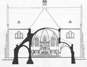
Abb. 4. Querschnitt durch das Schiff. — 1:500.
