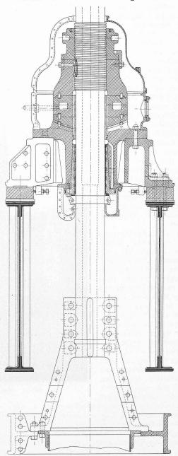
Abb. 13. Oberes Wellen-Ende mit Spurlager. — 1:30.
