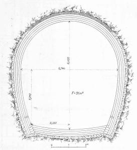
Abb. 5. Querprofil des Ablaufstollens. — Masstab 1:100.
