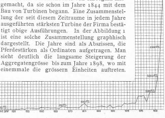
Abb. 1. Zusammenstellung der in jedem Jahre von Escher Wyss & Cie. gebauten grössten Turbinen.
