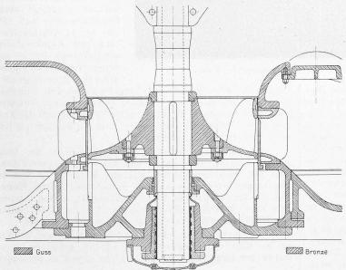
Abb. 12. Detail der untern Hälfte der 10000 P.S. Doppelturbine 1:30.
