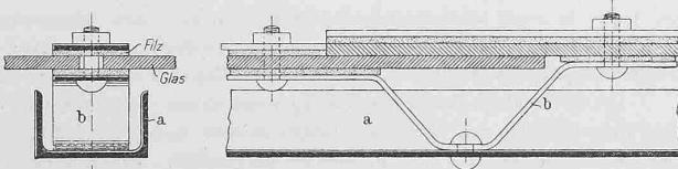
so geformt ist, dass er federt, zwischen den Sprossen α und die Glasplatte als deren Träger angeordnet ist und abwechselnd mittels Schrauben und Nieten mit den Sprossen und Glasplatten in Verbindung steht. Der Träger bildet dabei ein einfaches und bei verhältnismässig hoher Tragkraft äusserst leichtes Verbindungsmittel, das sich der ungleichen Ausdehnung der verschiedenen Materialien vollkommen anpasst und dadurch ein Springen der Glasplatten so gut wie ausschliesst.
