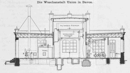
Abb. 4. Wäschereigebäude. — Schnitt durch Kessel-, Reservoir- und Maschinenraum.
