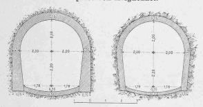
Abb. 15. Querprofile des Zulaufstollens. - 1:150.
