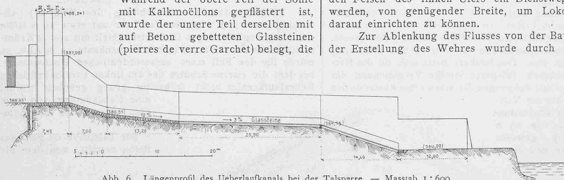
Abb. 6. Längenprofil des Ueberlaufkanals bei der Talsperre. — Masstab 1:600.
