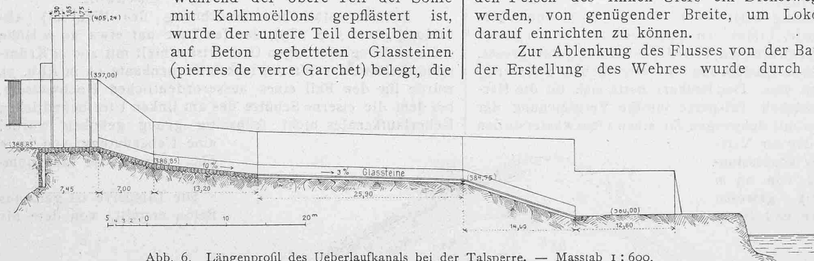
Abb. 6. Längensprofil des Ueberlaufkanals bei der Talsperre. — Masstab 1:600.
